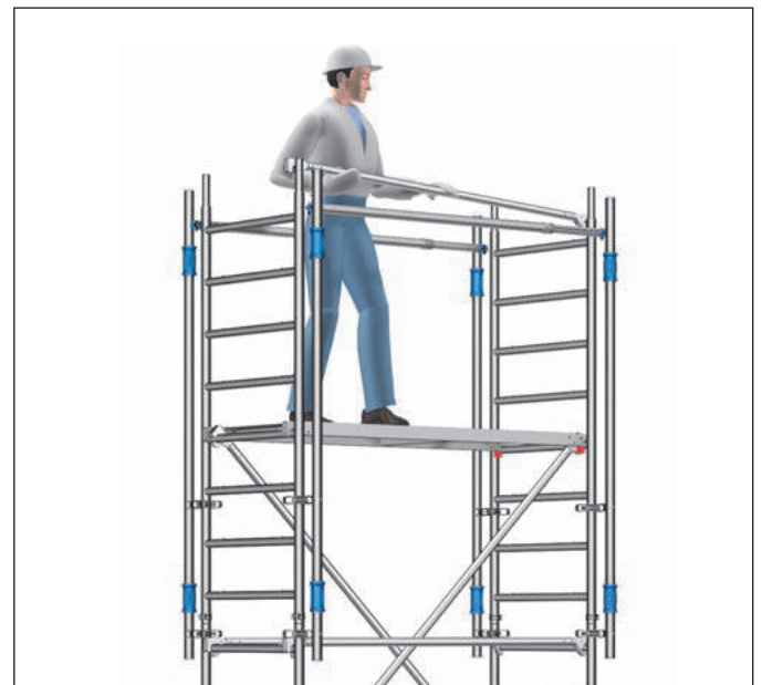
Bild 6: Sichere Montage der Rückenlehnen mit MSG
