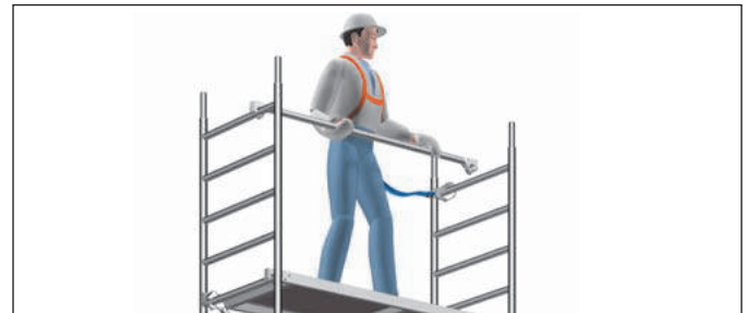
Bild 3: Sichere Montage der Rückenlehnen mit PSA
