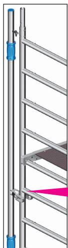
Bild 4: Anschluss Montagepfosten an der Standleiter
